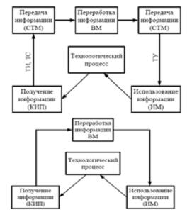
структурная схема частичной автоматизации - местной автоматизации
